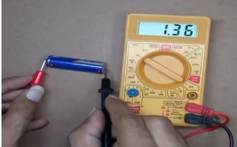
८. Resistance नाप्ने Multimeter को Switch On गरी Selector Switch लाई ohm ( $\Omega$ ) लेखिएको ठाउँमा Set गर्ने ।
