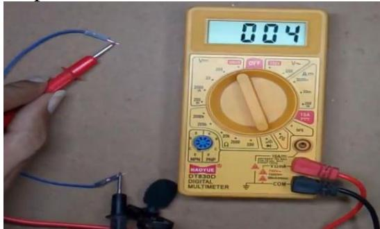
१४. AC Current नाप्न Multi Meter को Switch On गरी Selector Switch लाई AC Current लेखिएको ठाउँमा Set गर्ने ।
