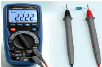
१२. Continuity नाप्ने Multi Meter को Switch On गरी Selector Switch लाई Buzzer लेखिएको ठाउँमा Set गर्ने ।
